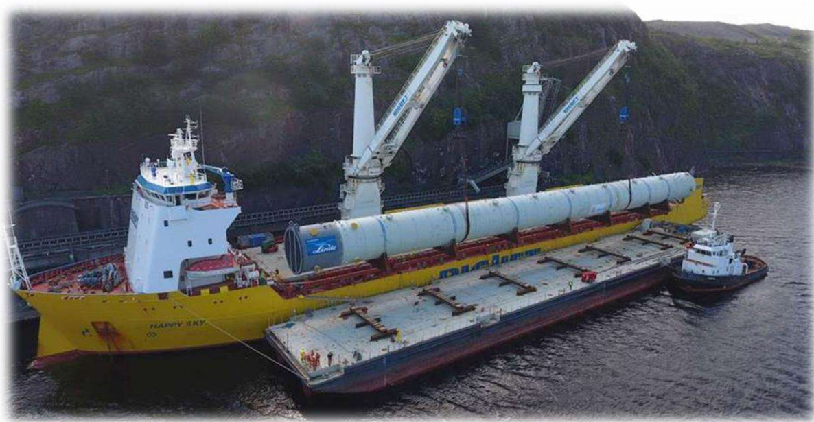
Перегрузка С3-сплиттера (длина 106 м, масса 917 тонн) с морского судна на баржу
