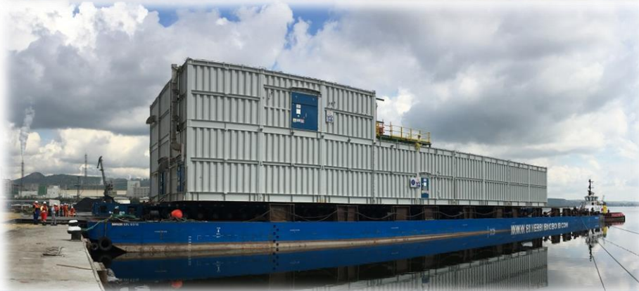
Процесс погрузки накатным способом модуля массой 1100 тонн на баржу
