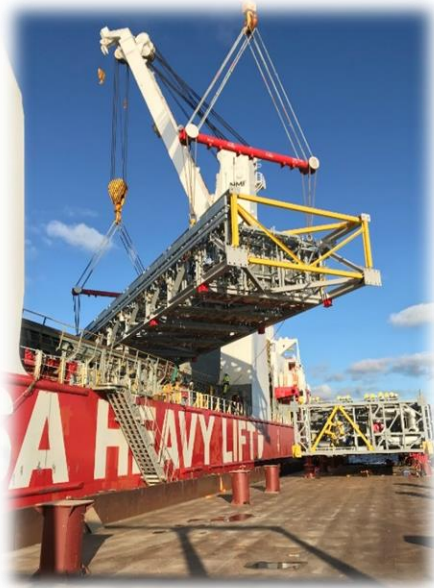
Перегрузка модулей с кранового судна на баржу
