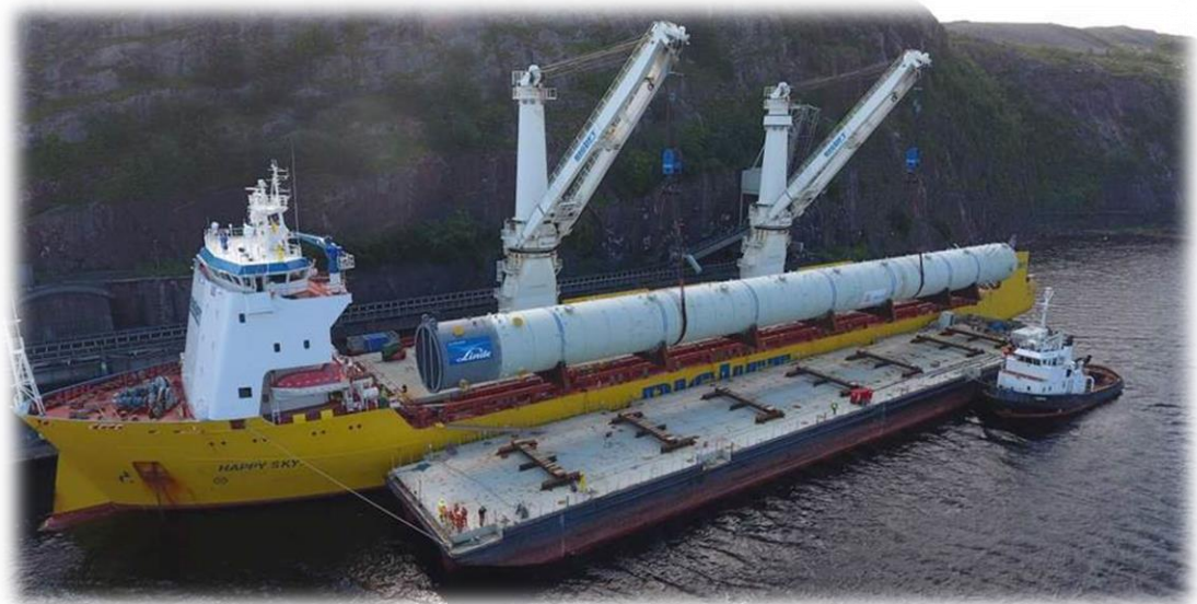
Перегрузка С3-сплиттера (длина 106 м, масса 917 тонн) с морского судна на баржу
